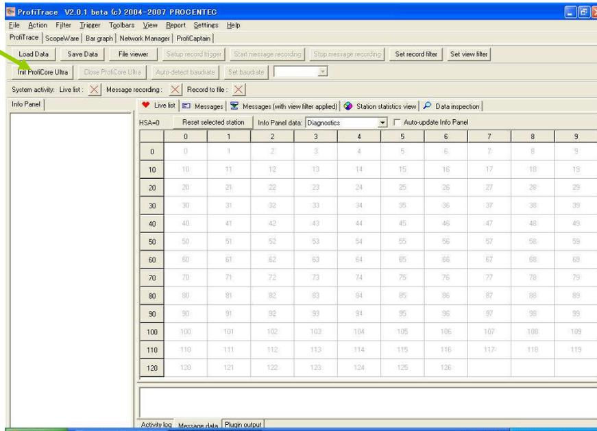
ProfiCoreの初期化後、速度の自動検知が始まり、以下のような画面が出てきます
