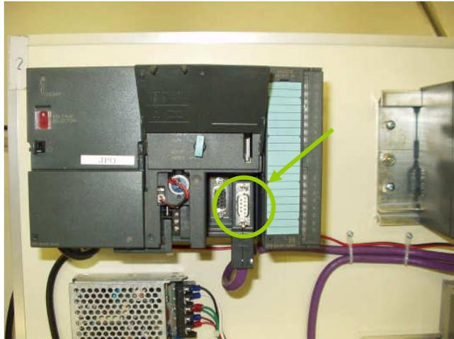
Tap connectorの片方を背面コネクタに、もう片方をProfiCore UltraのPROFIBUS接続口に接続します。ProfoCore Ultraの反対側からUSBケーブルで、PCに接続されます。
